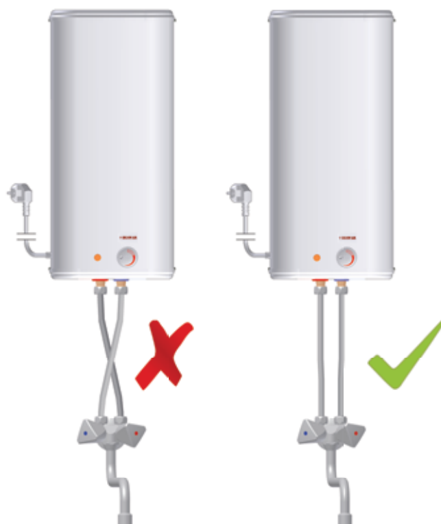
Rys 5. Prawidłowe połączenie podgrzewacza z baterią wodną.
